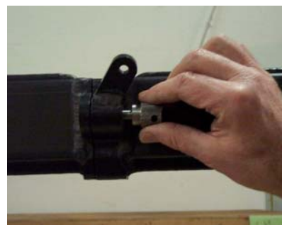
Sicherung durch seitliche Sicherungsschrauben
