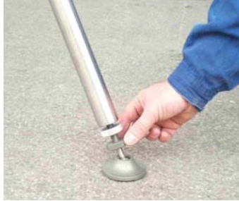
Nivellieren der Stellschraube
