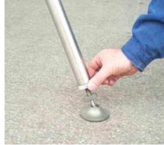
Sichern der Stellschraube
